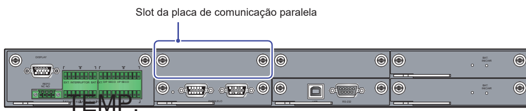
(Figura 4-12: Localização do slot da placa de comunicação paralela)
