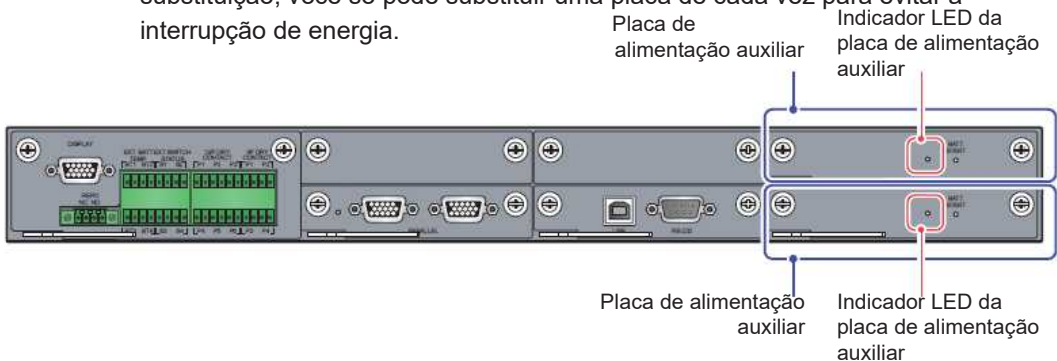
(Figura 4-17: Localização das placas auxiliares de energia e seus indicadores LED)
